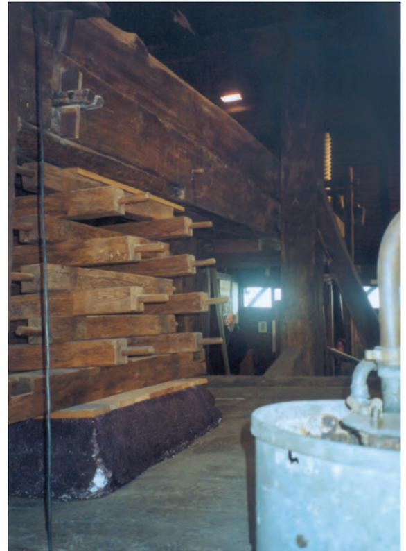
Bild 14: Die Metzinger Kelter im Bild: Biet und Bracken im Vordergrund, darüber der mächtige Kelterbaum, ganz hinten die Spindel (Foto: Lothar Buck)
