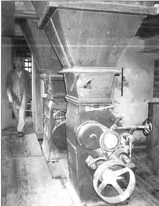
Mahlgut im Beutelkasten geklopft, damit das feine Mehl herausfiel, jetzt fand dieser Arbeitsgang in Sichtmaschinen statt. Eines der frühen Modelle war der Rundsichter. In einem leicht geneigten Sechskantzylinder fiel durch die Drehbewegung das Mahlgut hart auf die Sichtflächen auf, die mit Gaze bespannt waren. Für den ganzen Prozeß wurden mehrere Sichter mit unterschiedlicher Bespannung benötigt.
